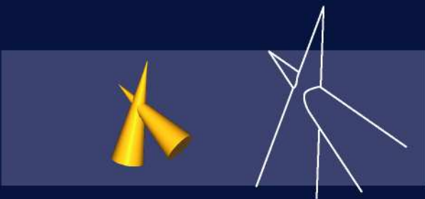
Berechnung und Darstellung von Schnittkurven*
